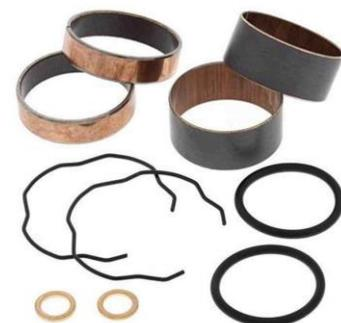
Gabel wird dann sehr schnell undicht. Oft ist das Undicht werden der Gabel auch genau der Hinweis auf den Verschleiß. Somit empfehlen wir die Gleitbüchsen mit allen weiteren Teilen auszutauschen. Die Sprengringe verrosten auch oft, da Wasser unter die Staubkappen eindringt. Am besten gleich das Set bestellen, doch auch Einzelteile sind lieferbar. Alle Teile werden im Paar (also für 2 Holme geliefert).
