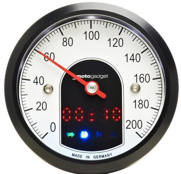
Der wunderschöne klassische Minitacho (ohne Drehzahlmesser) motoscope tiny mit seinen 49mm Durchmesser und einer Tiefe von nur 23mm ist ein absolutes Highlight an jedem Motorrad. Funktionen: Tacho (über 200km/h zeigt er die Geschwindigkeit digital), Uhrzeit, Tages- und Gesamtkilometerzähler, max. Geschwindigkeit und dazu auch 4 Kontrollleuchten. Wie bei allen motogadget Instrumenten ist im Lieferumfang alles enthalten was zum Anschluss und Betrieb notwendig ist:
