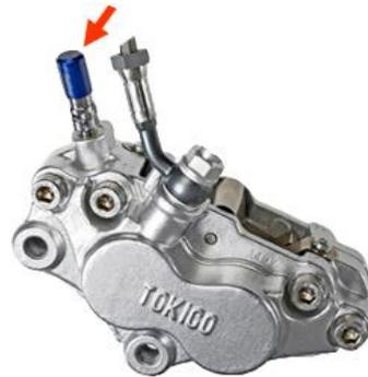
Diese patentierten Stahlbus Bremsenentlüftungsventile sind ein geniales Ergebnis deutscher Ingenieurskunst! Mit diesen Ventilen lässt sich die Bremsanlage spielend leicht entlüften, denn das Sicherheitsventil in der Entlüftungsschraube verhindert das beim Aufdrehen der Entlüfter Luft in das System eindringen kann. Somit ist es nicht mehr notwendig den Nippel ständig auf und zu zu drehen, sondern man
