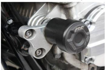
wurde. Alle Modelle haben Kunststoffpads mit 60mm Durchmesser, des Weiteren sind sie mit einem großen Radius versehen, um die Gleiteigenschaften zu verbessern. Falls die Pads mal leicht beschädigt werden sollten (z.B. bei einem Umfaller), können die Endkappen der Pads einfach getauscht werden.
