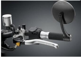
Die Spiegel Spirit RS sind die konsequente Weiterentwicklung der Spiegel Spirit. Der Haltemechanismus wird außen in die Lenker eingesteckt und verklemmt wie ein Lenkerende. Daher ist die Montage an nahezu jedem Lenker möglich. Eine Verwendung von zusätzlichen Lenkerenden entfällt. Stückpreis mit ABE. Adapter mitbestellen!
