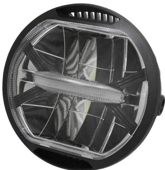
Ein sehr moderner Scheinwerfer ist der neue Thunderbolt mit 170mm Außendurchmesser. Er besitzt ein sehr flaches Gehäuse mit nur 86mm Tiefe. Er eignet sich hervorragend für radikalere Umbauten mit einer Reduzierung der Elektrik, denn diese muss unter den Tank verlegt werden, da es keinen Stauraum im Scheinwerfergehäuse gibt. Das Scheinwerfergehäuse ist mit Kühlrippen versehen um den Hochleistungsscheinwerfer nicht zu heiß werden zu lassen.
