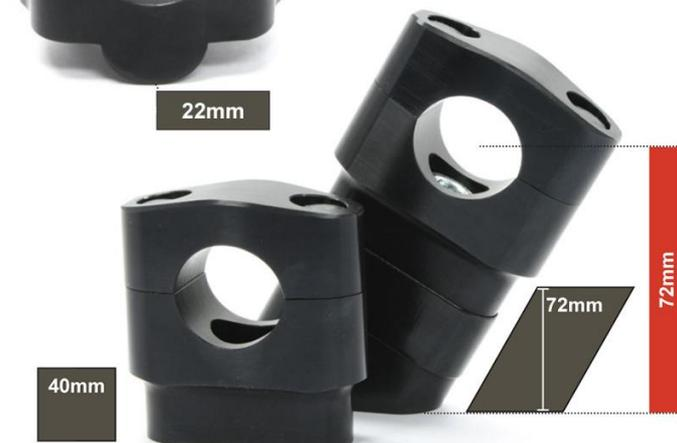
Sitzposition, die 34° Risers, da der Lenker näher zum Fahrer rückt! Bis 50mm Höhe mit Serienleitungen und Zügen kombinierbar. Ab 58mm muss es genau ausgemessen werden!
