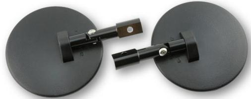
Diese kleinen Spiegel werden einfach an die Lenkerenden von Alu- oder Stahllenkern angeschraubt (nicht für Kellermann Lenkergewichte geeignet). Montage nur mit längeren M6er Schrauben möglich, die wir für 1,- Euro Aufpreis gerne mitliefern. Spiegelfläche mit ABE, Durchmesser 100mm. Sie sehen hervorragend aus!
