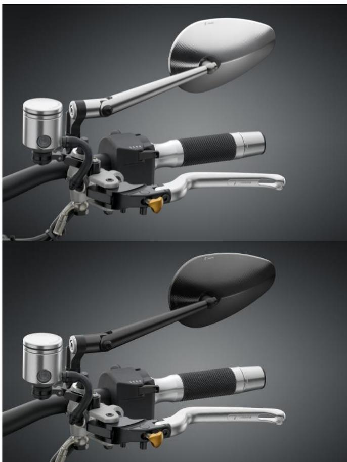
Wunderschöner 3D-gefräster Aluspiegel. Das bläuliche Glas ist konvex geformt und mit einer Größe von 137mm x 83mm auch ABE konform. Die Spiegel werden mittels Adaptern an die Lenkerhalterung montiert. Diese müssen separat bestellt werden. Alle Preise sind Stückpreise.
