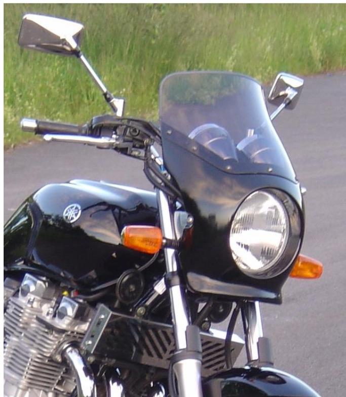
Lampenverkleidung für den originalen Scheinwerfer; sie wird am Scheinwerferhalter befestigt. Diese klassische Verkleidung passt sehr gut zum Erscheinungsbild der XJR. Der Windschutz dieser Verkleidung ist hervorragend und macht sich gerade auf längeren Autobahnetappen deutlich bemerkbar.
