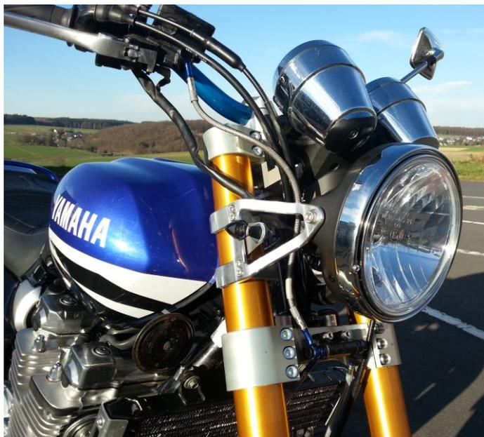
Ein wunderschöner Ersatz für die gegossenen Serienscheinwerferhalter sind diese CNC gefrästen Halter mit 125mm Abstand von Standrohrmitte zur Haltebohrung der Scheinwerfer. Bei den Standrohrdurchmessern sind alle Maße zwischen 38 und 56mm lieferbar, daher bitte das gewünschte Maß angeben. Die Seriengabel hat 43mm Standrohre. Geliefert werden die Halter immer im Paar. Die Scheinwerferhalter sind nicht mittels Schellen am Standrohr befestigt, sondern durch spezielle Klemmungen.
