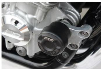
Mit diesen formschönen und perfekt verarbeiteten Sturzpads können im Falle eines Sturzes oder alleine beim Umfallen des Motorrades Schäden an Motor, Rahmen und Verkleidung verhindert oder zumindest stark eingeschränkt werden. Rechts oder links gefallen, ein Motordeckel ist immer hin! Nichts ist ärgerlicher
