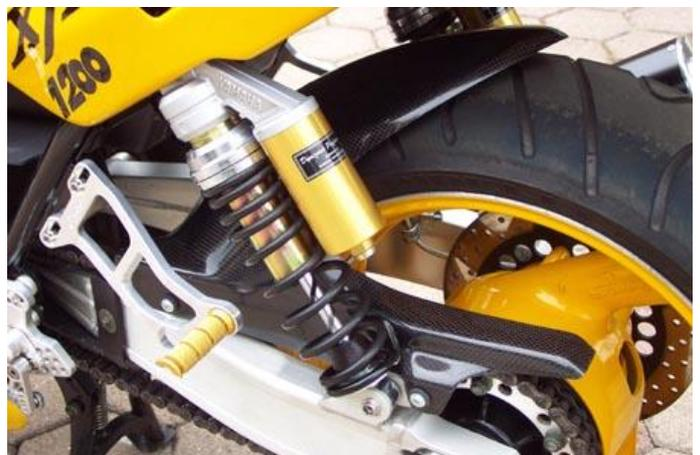
Das passende Gegenstück zu unseren XJR Vorderkotflügeln „Road“ ist die XJR Hinterradabdeckung „Road“, die wir auch in GFK und Carbon anbieten. Diese sind gegen Aufpreis lackiert lieferbar (Bitte mit Farbangabe anfragen). Die Hinterradabdeckungen haben einen integrierten Kettenschutz.
