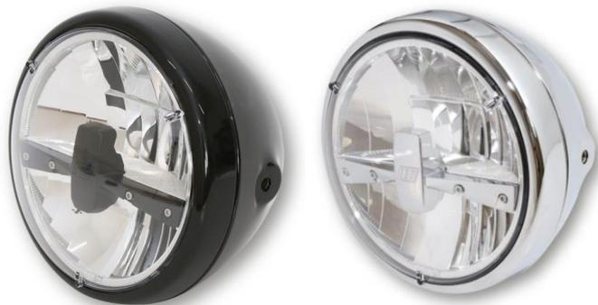
LED Scheinwerfer Reno ist ein Hochleistungsscheinwerfer mit sehr guter Lichtausbeute. Das Abblendlicht besitzt 18Watt, das Fernlicht 30 Watt. Die Gehäusebreite beträgt 200mm Somit ist er nur minimal schmaler als der Serienscheinwerfer der XJR. Die Haltepunkte müssen minimal ausdistanziert werden. Der Anschluss des Scheinwerfers erfolgt ebenfalls über den Standard Scheinwerferstecker der XJR.
