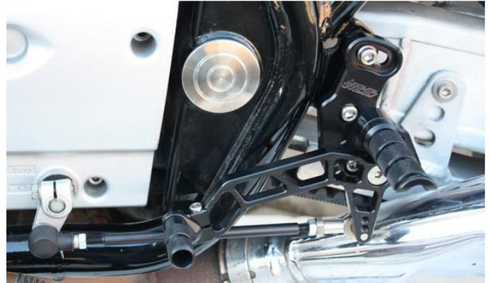
Eine der edelsten Rastenanlage, die je für die XJR gefertigt wurde, ist diese High Performance Anlage. Die sind mannigfaltig verstellbar, die Rastenposition ist über einen Drehpunkt in allen möglichen Positionen zu fixieren. Hinzu kommt, dass die Rastenanlage am Rahmen über ein Langloch schwenkbar ist. Somit lässt sich nahezu jede gewünschte
