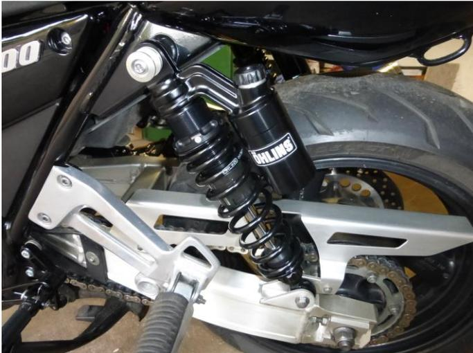
Die Öhlins Black-Line Stoßdämpfer sind von der Technik und vom Verstell-Bereich her nahezu identisch mit den Öhlins S36 PR1C1L. Somit bieten sie auch volle Einstellbarkeit. Welche Federbeine für Dich passend sind, entscheidet die Optik.
