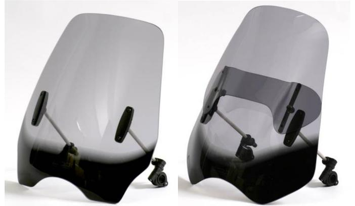
Die ca. 350mm lange Vario-Tour Scheibe (Bild unten links) ist der Tausendsassa unter den Scheiben. Ihr riesiger Vorteil ist, dass sie genau auf die Bedürfnisse des Fahrers eingestellt werden kann. Die Neigung der Scheibe ist über den Haltesatz möglich und der Windstrom kann mittels des aufgesetzten Spoilers genau in die gewünschte Höhe gelenkt werden. Somit lässt sich die Scheibe auf jede Fahrergröße einstellen. Für die Montage aller
