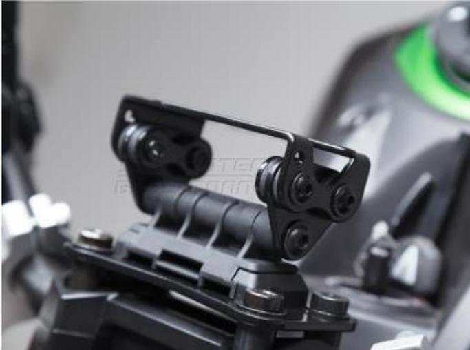
Der Halter wird an den Schrauben zur Lenkerklemmung mit befestigt. Er ist einstellbar und auch abnehmbar. Die Grundplatte bleibt am Motorrad.
