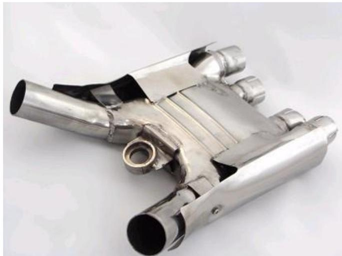
Neben dem oben aufgeführten, filigranen Sammler, bieten wir auch einen Nachbau des RP06/RP10 Sammlers an. Hierfür empfehlen wir, gleich die Dichtungen für Krümmer zum Sammler und von Sammler zu den Endschalldämpfern mitzubestellen, da zumindest die Krümmerdichtungen in keinem Fall weiter verwendet werden können.
