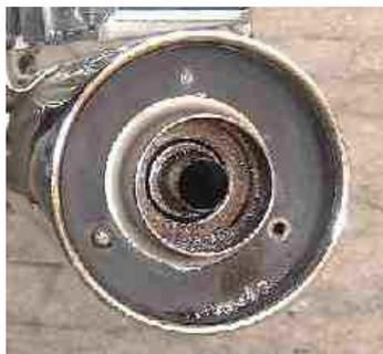
Heiß begehrt sind unsere Edelstahl-Auspuffänderungen. Der Auslass der Seriendämpfer wird von innen 20mm auf 28mm vergrößert und die Umlenkung in der letzten Kammer des Dämpfers wird umgangen. Der Sound wird deutlich dumpfer aber nur mäßig lauter. Das Fahrgeräusch erhöht sich um ca. 4 DB. Somit liegt es normalerweise innerhalb des Toleranzbereiches. Eine ABE
