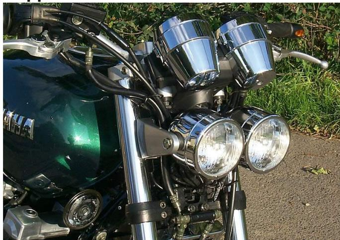
90mm Doppelscheinwerfer. mit H4 60/55Watt und H7 Glühbirnen. Aufgrund der Einbaubreite von 217mm passt er auch ohne Haltesatz an die originale Befestigung der XJR. Es muss nichts ausdistanziert werden.
