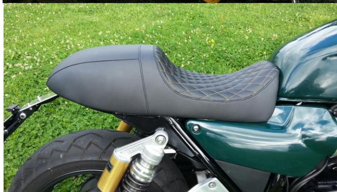
Der Grund für die Entscheidung zur Volleder Sitzbank liegt in der Prüfpflicht von Glasfaserteilen. Es muss ein Splittergutachten vorliegen. Da aber bei uns kein GFK außen offen ist, kann nichts splintern, somit gestaltet sich die Eintragung deutlich einfacher!
