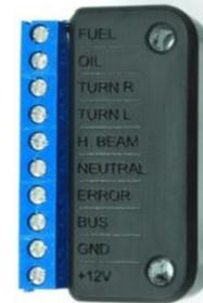
Ein weiterer kleiner Helfer ist die Breakout box, die die zentrale Steuerung der Kontrollleuchten übernimmt. Sie kann auch irgendwo am Fahrzeug befestigt werden und zur Kontrolleinheit muss auch nur noch ein Signalkabel verlegt werden. Bei der Verwendung des Digitalinstrumentes motoscope pro ist für die Funktion der Kontrollleuchten die Verwendung des Breakout zwingend erforderlich.
