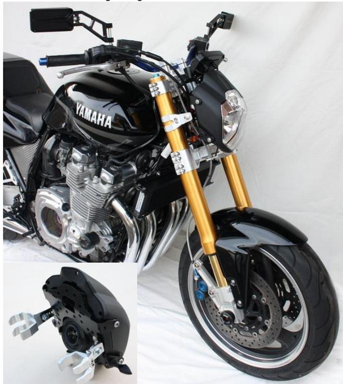
Das untere Foto zeigt unseren filigranen Scheinwerferhalter mit Adapterkit speziell für den MT03 Scheinwerfer. Der Scheinwerfer wird mittels einer Platte auch von hinten abgedeckt. Für die Bestellung unbedingt den Gabeldurchmesser angeben. Die Gabelklemmungen sind in silbern (si) und schwarz (sw) lieferbar. Haltekit ist schwarz.
