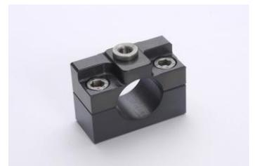
Jeder neue Lenker muss angebohrt werden. Feilt NIEMALS die Arretierungen der Armaturen ab, weil Ihr Angst habt den Lenker anzubohren! Die Armaturen werden sich mit der Zeit mitdrehen und nie wieder richtig fest bleiben. Die Lenker sind dafür ausgelegt, dass sie für die Arretierung angebohrt werden müssen. Bei den Alu Lenkern ist es oft nicht einmal erforderlich die Löcher komplett durch zu bohren, aber angebohrt werden müssen sie, alles andere ist wahrlich Pfusch!
